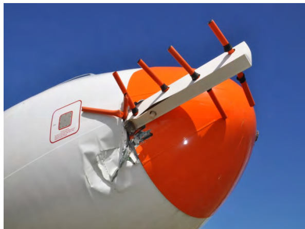
Foto 29: parte antenna localizzatore nel musetto.
