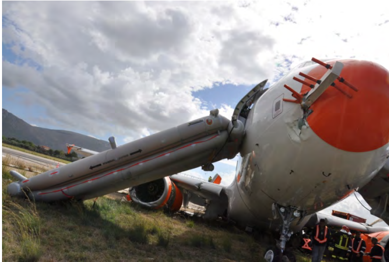
Foto 32: scivoli anteriori utilizzati per l'evacuazione.
