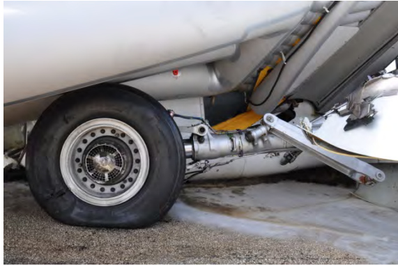
Foto 3: particolari dei danni al carrello destro.
