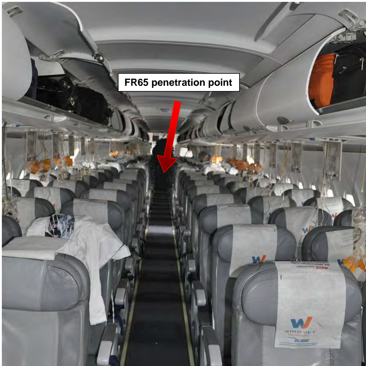
Foto 37: punto di penetrazione in cabina del cross beam FR65.
