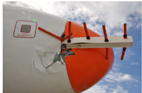
Foto 6: particolare dei danni al radome.
