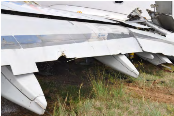
Foto 13: danni alla semiala sinistra.
