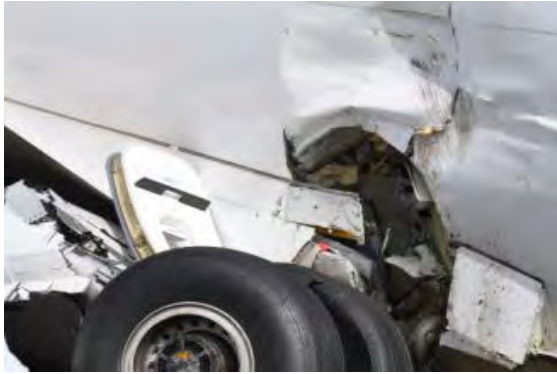
Foto 11: danni del carrello sinistro sulla fusoliera.
