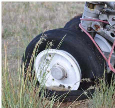
Foto 28: fune avvolta sul carrello anteriore.
