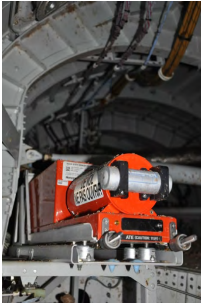
Foto 22: i registratori di volo prima e dopo lo sbarco dall'aeromobile.
