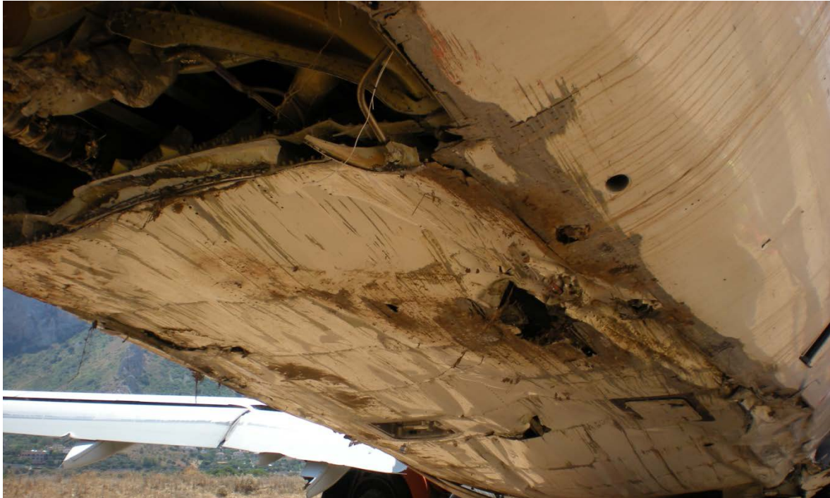
Foto 39: vista dei danneggiamenti della parte inferiore della fusoliera.
