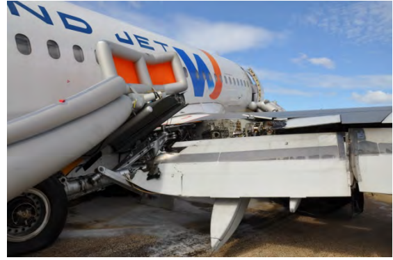
Foto 12: danni prodotti dal carrello destro.
