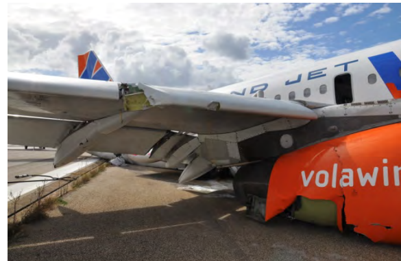
Foto 14: danni alla semiala destra.
