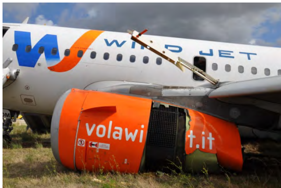
Foto 5: particolare dei danni al motore sinistro.
