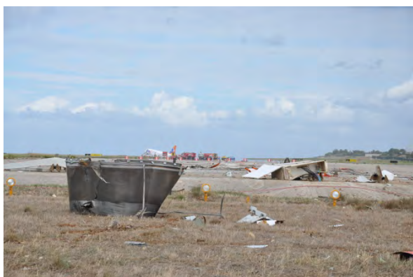
Foto 26: cono di scarico del motore sinistro.
