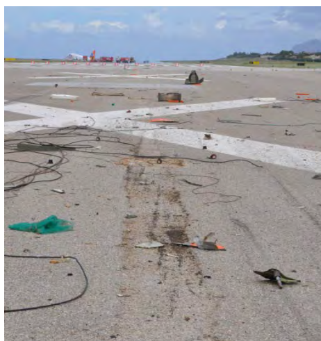
Foto 31: tracce e detriti presenti in pista.
