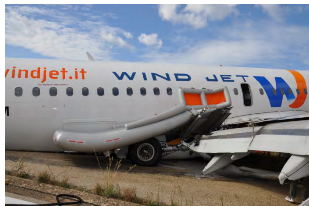
Foto 36: uscita alare destra e relativo scivolo.
